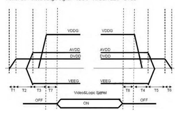
0<T1≤10ms T5>0ms T2>20ms T6>0ms T3>10ms 0<T7≤10ms T4>0ms 0<T8≤10ms
